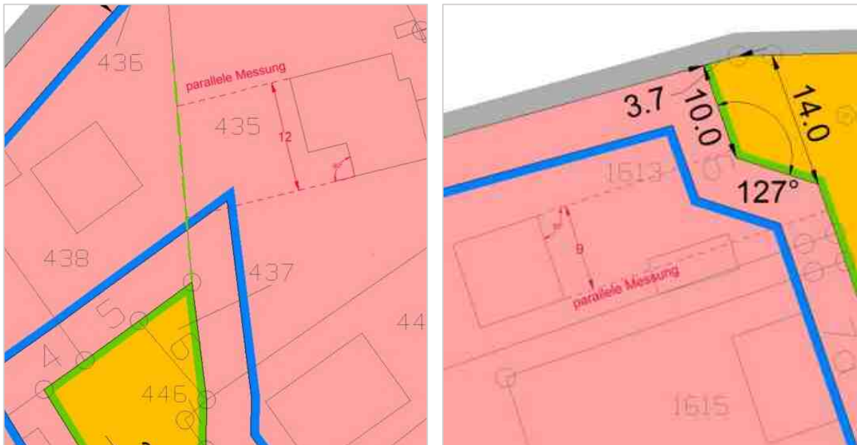
Beispiel 1: Ergebnis der Messung der Tiefe = 12 m Beispiel 2: Ergebnis der Messung der Tiefe = 9 m
