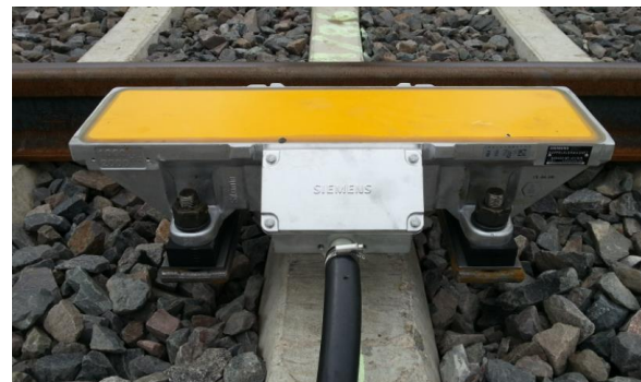
Punktförmige Zugbeeinflussung (PZB) - Magnet
