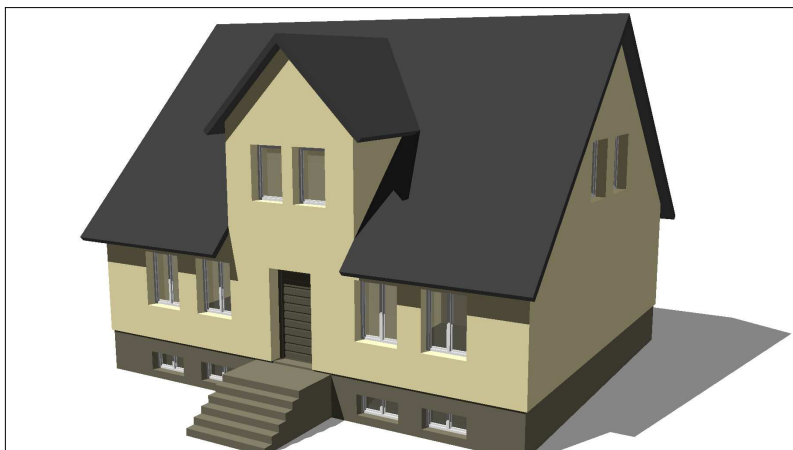
Bild 15: Hauptdach als Satteldach mit unterbrochener Traufe, Zwerchgiebel mit Satteldach in der Neigung des Hauptdachs
