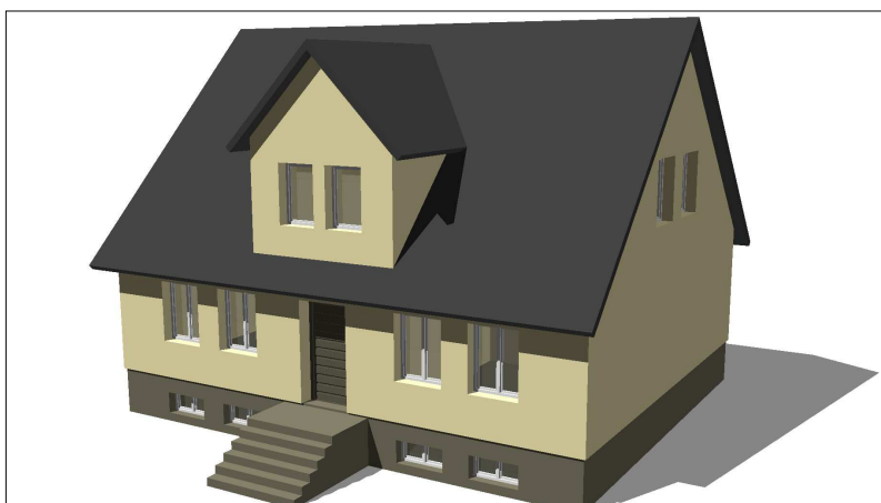
Bild 14: Hauptdach als Satteldach mit geschlossener Traufe, Zwerchgiebel mit Satteldach in der Neigung des Hauptdachs; 1,10 m breite Fenster im EG mit senkrechter mittiger konstruktiver Teilung; 0,90 m breite Fenster im Zwerchgiebel ohne Teilung
