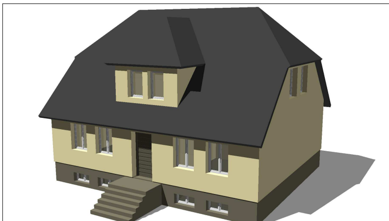
Bild 8: Hauptdach als Krüppel- walmdach mit Walmdachgaube , Ansichtsbreite der Gaubenwand = 3,60 m; sämtliche Dachflächen in gleicher Neigung
