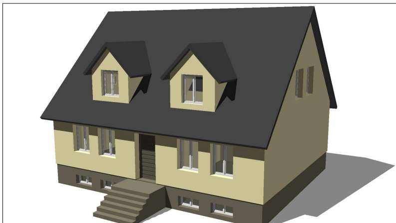
Bild 9: Hauptdach als Satteldach mit zwei Satteldach- gauben je 2,30 m breit
