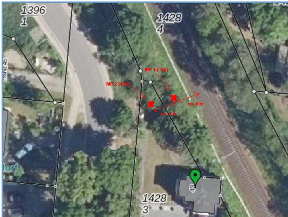
Abbildung 5-4: Anordnung der Messpositionen (MP) für beide Messaufnehmer am Messort 2 (Teilfläche nördlich Puschkinallee 43)
