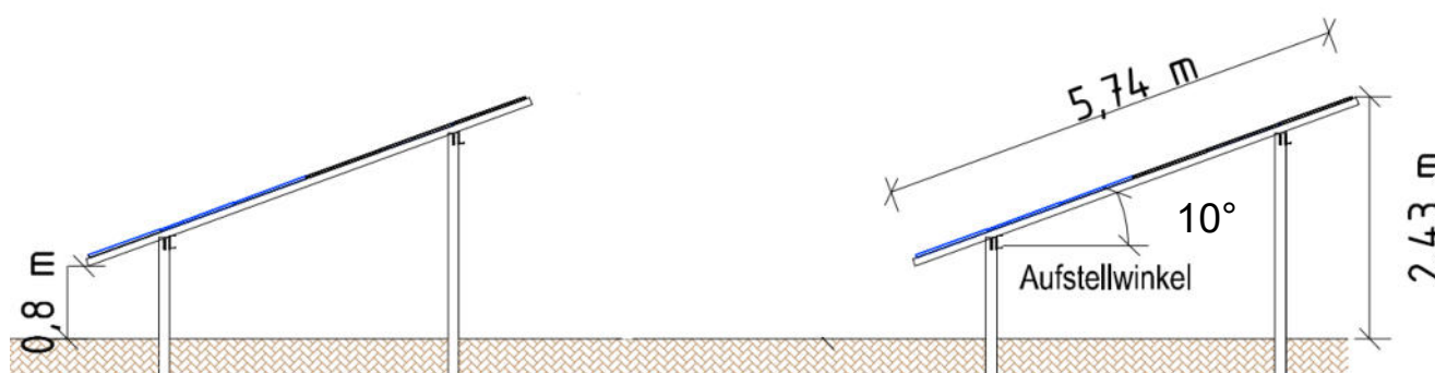
Bild 3.3.1: Skizzen der Modulkonstruktion (Quelle: Systemplanung, Auftraggeber)
